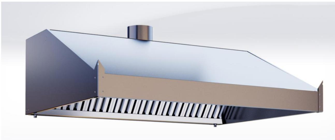
Предназначены для очистки воздуха от аэрозолей жира, масла, водяного пара. Разогретый воздух, насыщенный примесями, всасывается в зонт, проходит сквозь лабиринтный фильтр и, ударяясь о его поверхность, очищается и уходит в вентиляционную систему.
