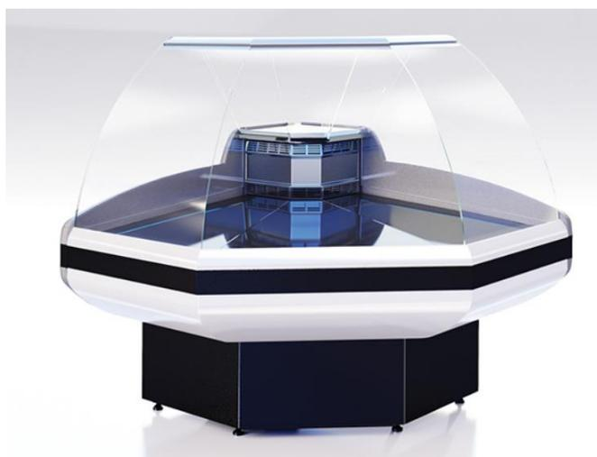
Угловая среднетемпературная холодильная витрина с глубиной выкладки 760 мм. Обеспечивает поддержание заданной температуры предварительно охлажденного товара. Имеет статическую систему охлаждения, оснащена люминесцентной подсветкой поверхности экспозиции. Витрина произведена с использованием комплектующих надежных европейских производителей: холодильный агрегат Aspera (Италия), высокоэффективный итальянский испаритель Sest, микропроцессорный блок управления.
