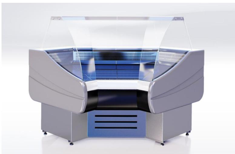
Угловая витрина Octava IC с глубиной выкладки 660 мм. Имеет статическую систему охлаждения, оснащена люминесцентной подсветкой поверхности экспозиции. Витрина произведена с использованием комплектующих надежных европейских производителей: холодильный агрегат Aspera (Италия), высокоэффективный итальянский испаритель Sest, микропроцессорный блок управления.
